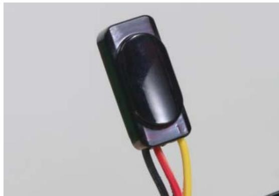
本产品基于 DToF 测距原理，集成了单光子雪崩二极管（SPAD）接收阵列以及 VCSEL 激光发射器。本产品可对物体 进行精确的距离测量而不受物体颜色、反射率和纹理的影响，利用自主研发的 SPAD 和独特的 ToF 采集与处理技术，可 实现最大 4 米的精确距离测量，快速检测频率可达 90Hz。
