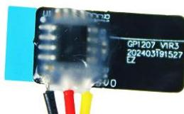
电容式液位感应器，适用于各种弧形、圆柱形等非金属容器。其原理是液位高低的变化引起等效介电常数变化，从而使感应器的电容量变化，当检测到电容值的变化超过设定的阈值时通过外置引脚输出低电平信号。
